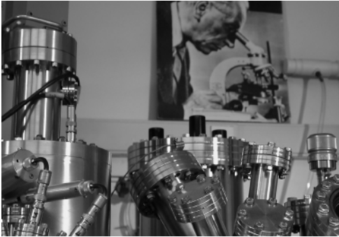
Figuur 2. Field ion- time of flight- atom probe microscoop met op de achtergrond Frits Zernike (Nobelprijs Natuurkunde 1953)
