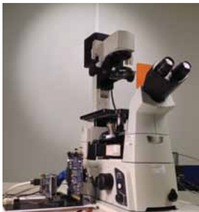
Figuur 3. Prototype van het nieuwe camerasysteem (links) aangesloten op een microscoop.
