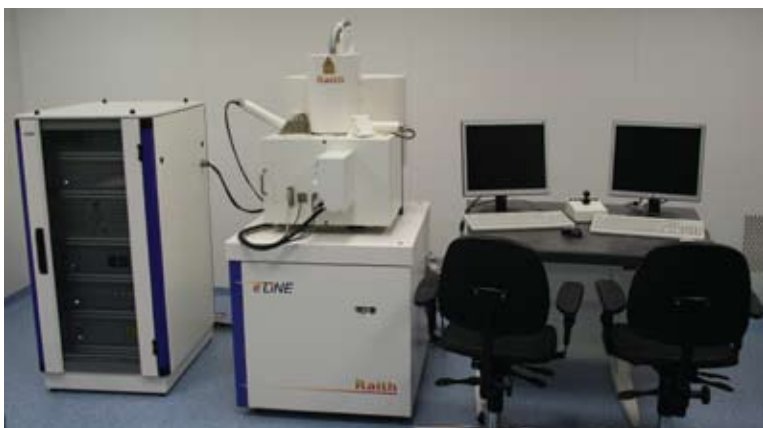
Figuur 1: Electronenbundelpatroongenerator. Locatie: gebouw 5111, naast de centrale clean room.
